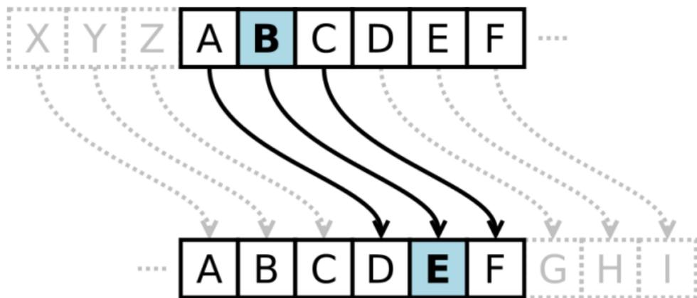
Le chiffre de César fonctionne par décalage des lettres de l'alphabet. Par exemple dans l'image ci-dessus, il y a une distance de 3 caractères, donc B devient E dans le texte codé.
